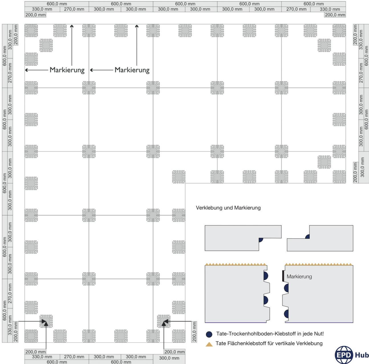
**Stützenanordnung:** Es ist darauf zu achten, dass die Eckstützen gerechnet von Mitte Stützenkopf 200 mm Abstand zu beiden Randanschlüssen aufweisen. Diese Positionierung ist zwingend einzuhalten.
